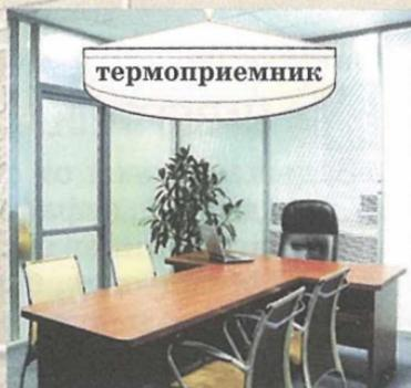
И вот, когда в доме жарко, Андрей предлагает включить поглощающий элемент, располагающийся под потолком в виде полусферы. К нему примыкает термобатарея, контактирующая с одним концом тепловой трубы. Другой конец тепловой трубы выведен из помещения наружу. Для удобства пользования в систему добавлен еще и регулятор, с помощью которого настраивается тепловой режим.
